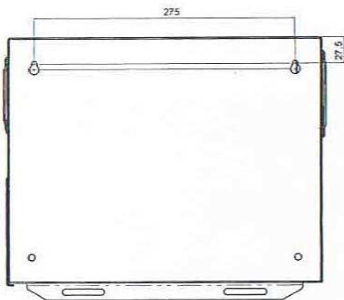
Габаритные и установочные размеры стабилизатора напряжения
