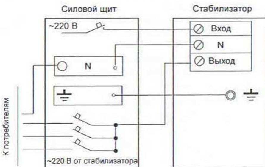
*Рисунок 1-Схема электрических соединений*
